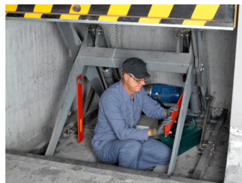
8 I dispositivi di blocco (puntelli), quando si trovano in posizione di sicurezza, proteggono il personale di manutenzione dall'abbassamento accidentale della piattaforma.
